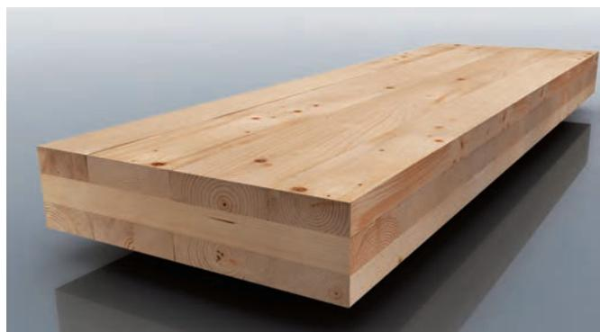
appartements, car la réglementation ne le permet pas encore pour des immeubles excédant huit étages. Ces poutres seront encoffrées avec du gypse. « On a tout intérêt à ce que ce matériau soit visible, car il participe à stabiliser le taux d'humidité ambiant, voire la température », expose André Bourassa.
